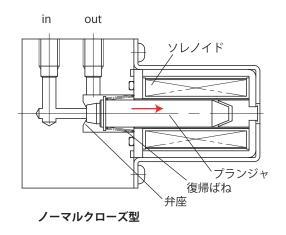
電磁弁の例です。流体や気体の流れを制御する電磁弁 はソレノイドで駆動されます。電磁弁にも、単純なオン とオフを切り替えるオンオフ弁のほか、比例的に圧力や 流量を制御する比例弁があります。また、構造的にもポ ペット型やスプール型など多くの型式があります。ここ
