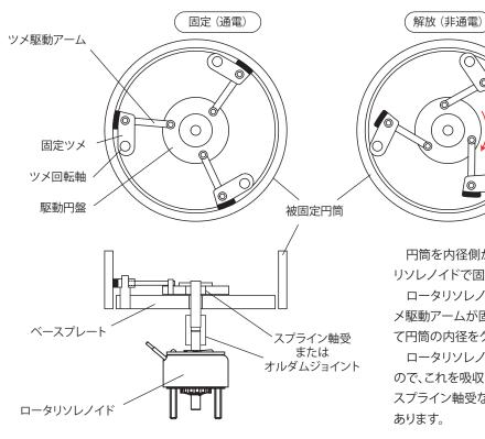
円筒を内径側からクランプする機構です。ロータ リソレノイドで固定ツメを駆動します。
