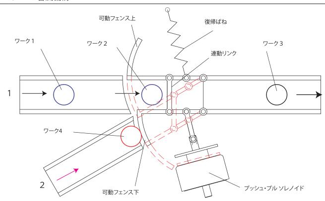
ワークの搬送機構で、2方向の流路から1方向に合流制御を行う機構です。切換流路は可動フェンス上と可動フェンス下で構成され、それぞれ独立して駆動します。連動リンクによるパラレルリンク機構で連結し、通路を「1」と「2」の方向に切
