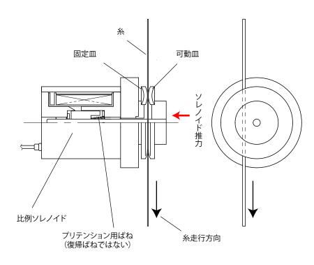
ミシンなどの糸の張力を制御するためのテンションコントローラです。固定皿と可動皿に挟まれた糸は、ここを通過するときに2枚の皿に加えられた荷重によってきます。比例ソレノイドはその有効ストローク内においては発生推力がはなって決まり、ストローク内においては発生推力には依存しません。このため、糸の太っに影響を受けず、電流値によって決まり、ストロークにないため、糸の太った、未通電時にも最低限のテンションが制御できます。テンションを得るために、プリテンション用ばねで与圧を与えています。
