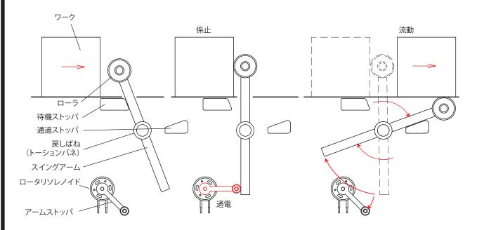
搬送経路中をランダムな間隔で流れてくるワークを、一定 間隔で流すように調整する機構です。
