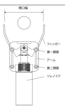
ソレノイドを使用したハンド機構です。ソレノイドの駆動ストロークと比べてフィンガーの開口幅を大きく取り、使い勝手に配慮しています。フィンガーの関節を2か所に設け、2段階動作を行います。ソレノイドは動作範囲の最終端付近で推力が大きくなるので、この付近でターゲットをしっかりと掴めるような動作を行います。
