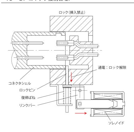
コネクタのロック機構です。コネクタシェルの挿入口の一部にロックピンが配置されています。このピンが突出した状態ですと、コネクタシェルは差し込むことができません。ソレノイドが未通電で消磁状態の場合、ロックピンはスプリングによって突出し、ロック状態です。ソレノイドに通電すると、リンクバーがロックピンを引き込み、ロック状態が解除されます。この状態ではコネクタシェルを接続状態まで差し込むことができます。
