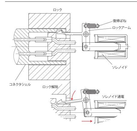
電子機器へのコネクタのロック状態をシステムで管理したいことはよくあります。そのような場合では、セキュリティの面などからコネクタを取り外してよいときにのみロックを解除します。コネクタシェルは、ソレノイド未通電状態で挿入するとロックアームにより固定され抜けなくなります。ソレノイドに通電すると、ロックアームはロック解除位置に駆動され、コネクタを抜き取ることが可能になります。
